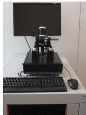
AFM с машиной разрыва
