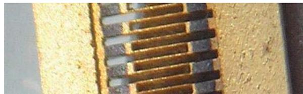
Рис. 2. Фрагмент планарной монокристаллической ЗС из поликристаллического алмаза
