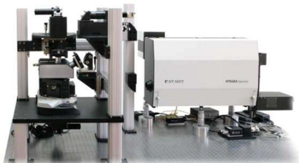
Многофункциональная автоматизированная АСМ/Раман/СБОМ/TERS система
