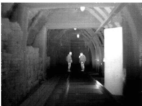
Регистрация изображения в ИК диапазоне с использованием микроболометрического приемника в условиях задымленности тоннеля (Фрагмент видимого изображения приведен выше). Удаленность спасателей - 20 метров.
