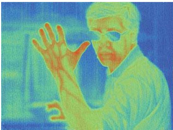
Пример регистрации теплового изображения в ИК диапазоне. Рабочая температура - 300К. Температурное разрешение - 60 мК. Быстродействие - 100 кадров/сек.
